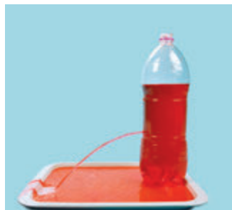
图9.2-1 液体从容器侧壁的孔中喷出
