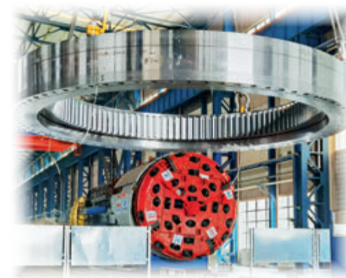
图8.3-8 我国自主研发的直径8 m的超大型盾构机主轴承
