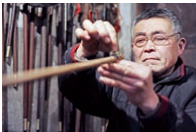
为秤杆安装精度卡口
