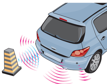
图2.3-4 利用超声波定位的倒车雷达
