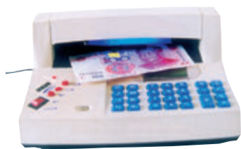
图4.5-7 紫外线使钞票上的荧光物质发光
