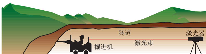
图4.1-5 激光引导掘进方向
