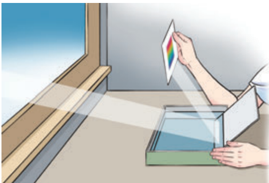
图4.5-2 光的色散实验
