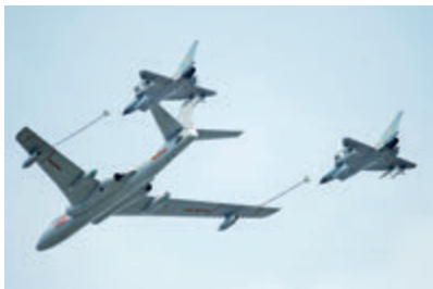
乙 加油机对受油机进行空中加油
