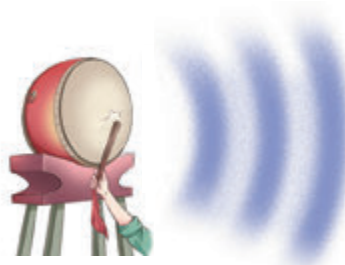
图2.1-5 鼓面的振动激起声波
