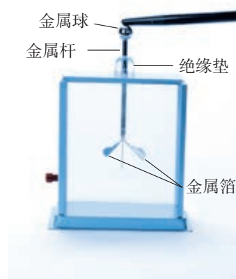
图15.1-2 验电器能显示物体是否带电
