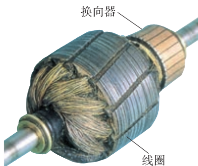
图 20.4-7 实际的直流电动机的转子
