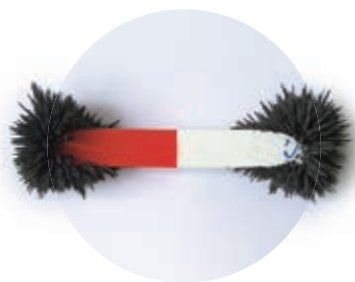
图20.1-3 条形磁体两端的磁性最强
