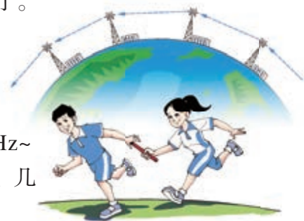
图21.4-1 微波中继通信示意图
