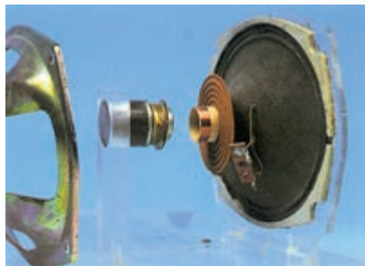
图 20.4-8 扬声器的结构
