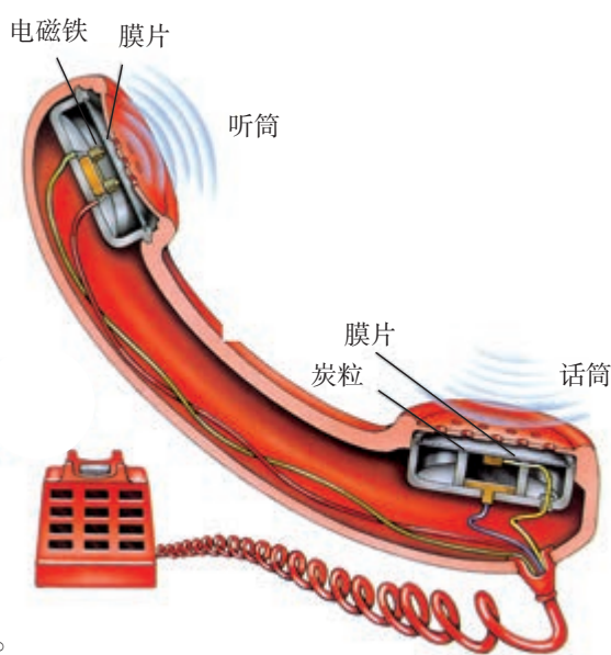
图 21.1-3 电话结构示意图
