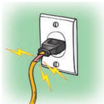
图 19.2-2 绝缘皮破损容易造成短路
