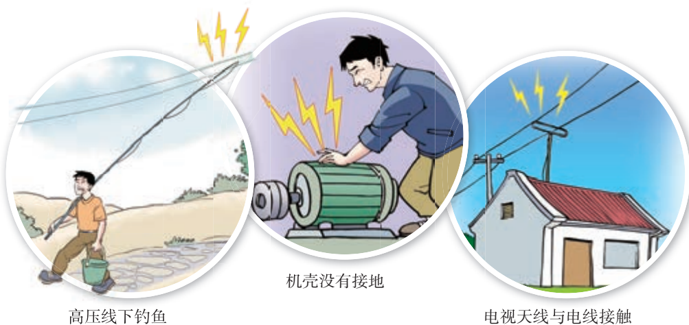
图 19.3-4 几种容易引起触电的情况
