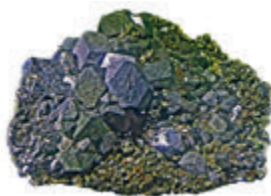
磁铁矿（主要成分是 \text{Fe}_3\text{O}_4 ）
