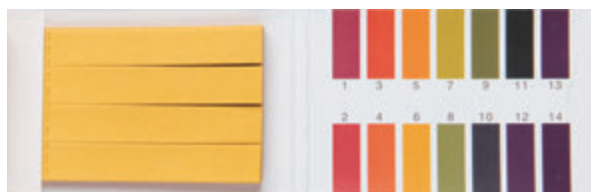
图10-2 一种pH试纸和标准比色卡
