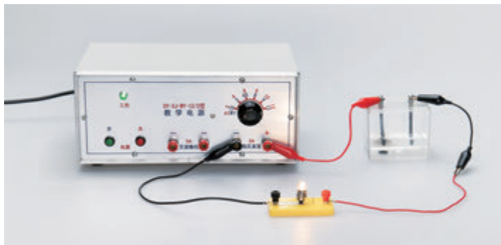
图 10-11 试验物质的导电性
