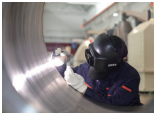
图8-8 我国工匠正在焊接火箭发动机喷管
