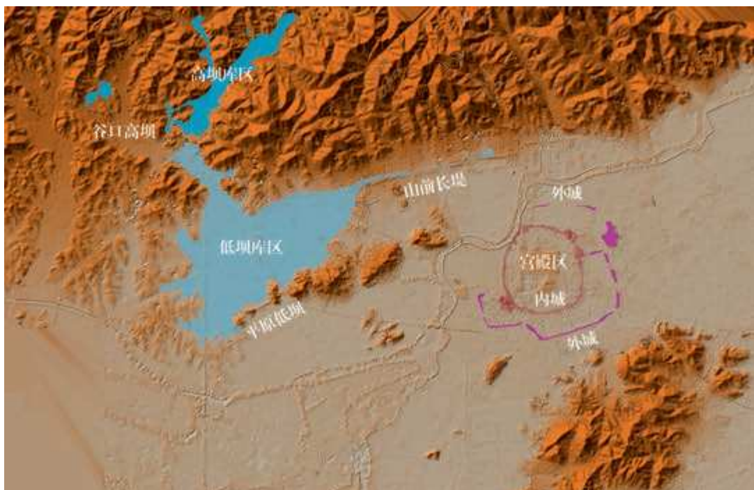
良渚古城及外围水利系统结构示意图
